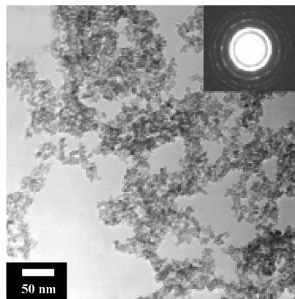
图 5  $H_3PW_{12}O_{40}/TiO_2$  的 TEM 照片
