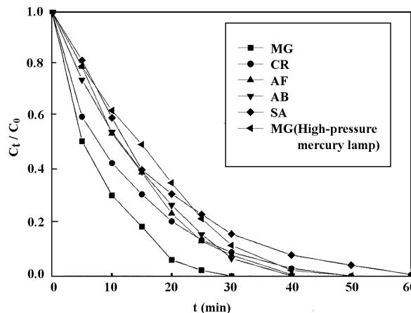
图 10 微波增强  $H_3PW_{12}O_{40}/TiO_2$  对不同有机污染物的光催化降解图Fig. 10 Degradation of different organic contaminants under MDEL and  $H_3PW_{12}O_{40}/TiO_2$  (dosage: 0.5 g)
