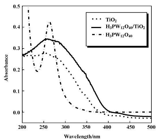
图 4  $H_3PW_{12}O_{40}/TiO_2$  的 UV/DRS 吸收光谱
