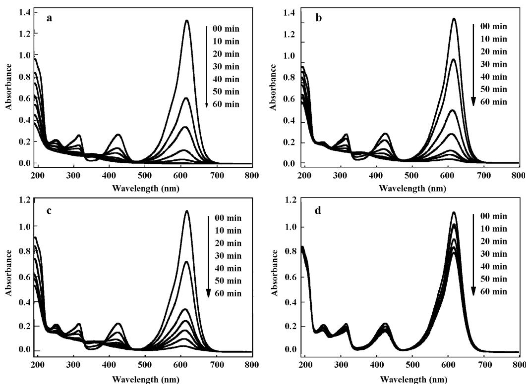
图 6 不同形状 MDEL 对 MG 溶液光降解的紫外-可见吸收光谱
