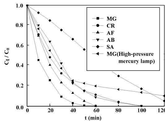
图 9 MDEL 对不同有机污染物的光催化降解图
