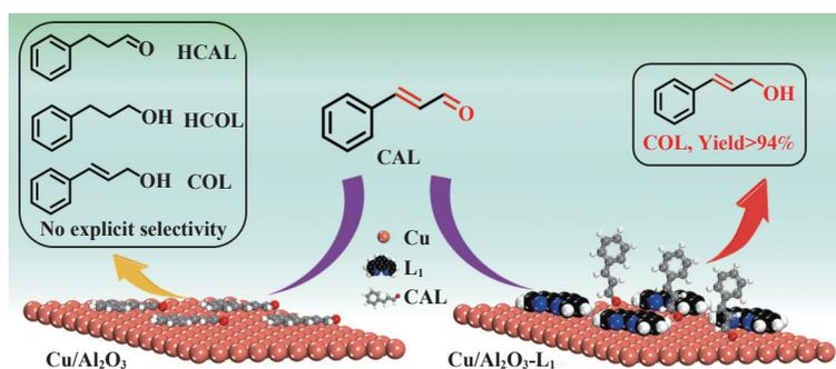
图 1 肉桂醛在  $\text{Cu}/\text{Al}_2\text{O}_3$  和  $\text{Cu}/\text{Al}_2\text{O}_3\text{-}L_1$  催化剂上的反应对比示意图
